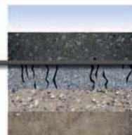
Пропитанная битумом ткань Fibertex AM2 выравнивает напряжения от трещин и швов в старой поверхности покрытия и препятствует их повторению через композитный верхний слой Densiphalt.
