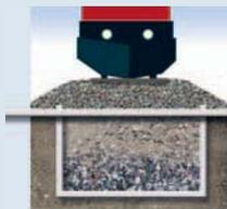
Всё более скоростные и тяжеловесные составы подвергают несущие слои сильным нагрузкам. Геотекстиль Fibertex стабилизирует основание, благодаря чему оно может выдерживать динамические нагрузки.
