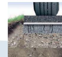
Благодаря пропитке битумом Fibertex AM2 не даёт поверхностной воде проникать вниз, в несущие слои, защищая содержащиеся в них мелкозернистые материалы от вымывания. Это позволяет сокращать появление трещин и выбоин в поверхности.
