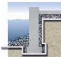
Уложенные под причальной стенкой геотекстиль Fibertex защищают дренажный слой, что снимает часть водяного давления со стенки. Если геотекстиль Fibertex уложены перед причальной стенкой, они защищают морское дно от размывания.
