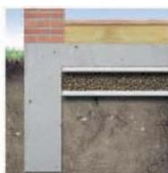
Уложенные под почвенным настилом водонепроницаемые геотекстиль Fibertex защищают дренажный слой от загрязнения со стороны бетона и основания.
