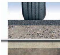
Твёрдые, статично нагруженные поверхности требуют стабильной основы. Геотекстиль Fibertex разделяет слои из различных материалов, обеспечивая, тем самым высокую несущую способность.
