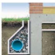
При строительстве фундаментов и подвальных стен геотекстиль Fibertex обеспечивает чистоту и эффективность окружающего дренажа, защищая здание от сырости.
