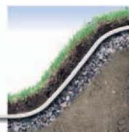
Благодаря слою геотекстиль Fibertex, уложенному под верхним слоем склона, обеспечивается его защита от почвенных, дождевых и талых вод, вымывающих мелкозернистый материал.
