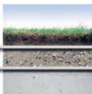
Геотекстиль Fibertex используются в качестве разделительного слоя и механической защиты мембран крыши, а также как фильтрозащита для любого дренажного слоя
