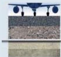
В конструкциях, покрытие которых испытывает сильные нагрузки, геотекстиль Fibertex стабилизирует несущие слои, благодаря чему они противостоят динамическим нагрузкам.
