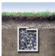
Геотекстиль Fibertex обеспечивают защиту дренажной системы от перемещения мелкозернистого материала.
