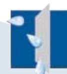
Гидравлические свойства геотекстилей Fibertex спроектированы с целью отводить избыток воды из конструкции – не путём её потока через геотекстиль, а путём направления её вдоль поверхности геотекстиля и вывода из конструкции. Геотекстиль обеспечивает постоянный отвод жидкостей при минимальной потере давления.
