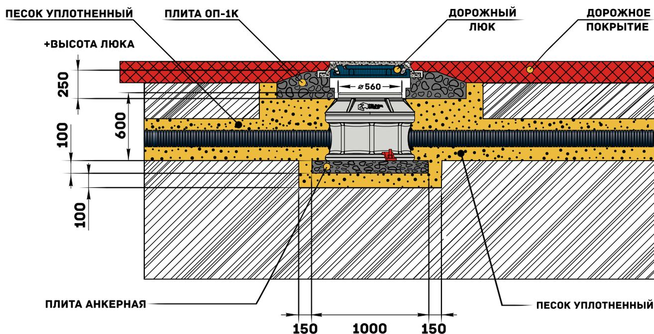
Установка кабельных колодцев КОД с крышкой D 560 мм на территории проезжей части выполняется с обязательным применением разгрузочных конструкций: железобетонной плиты серии ОП-1К (или аналога) и люка соответствующего класса нагрузки в соответствии с ГОСТ 3634-99.
